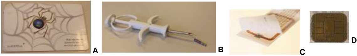
Abbildung 1: A: Kontaktlose Chipkarte, B: Glaszylinder für Tieridentifikation mit Applikator, C Smart-Label 3 , D: Verwandte Technologie: Goldchip
