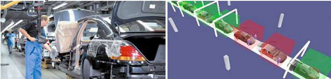
Abbildung 8: Fertigungssystem-Ortung mit UWB (vgl. Kap. 2.2) beim Fahrzeugbau
