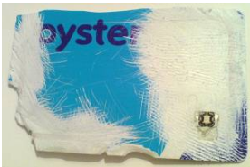
Abbildung 9: Teilweise zerstörte Oyster Card mit RFID-Tag rechts unten 32
